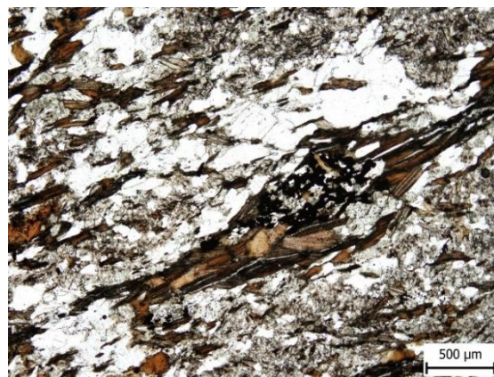
Obr. 6. Biotitická pararula s paralelní texturou, tvořená křemenem, biotitem, živci a rudními minerály, polarizační mikroskop, rovnoběžné nikoly (foto M. Šťastný).
