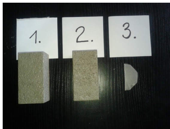
Obr. 2. Ochranný tvrdící potěr vodní sklo – akrylát (1), vodní sklo litné (2) na systému cement-akrylát detail (3). Foto P. Hájek.
