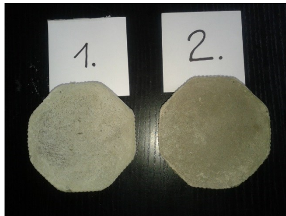
Obr. 1. Vsyp se struskou ATEMIT (1) a úpravou dotvrzovacího potěru systému vodní sklo (2). Foto P. Hájek.
