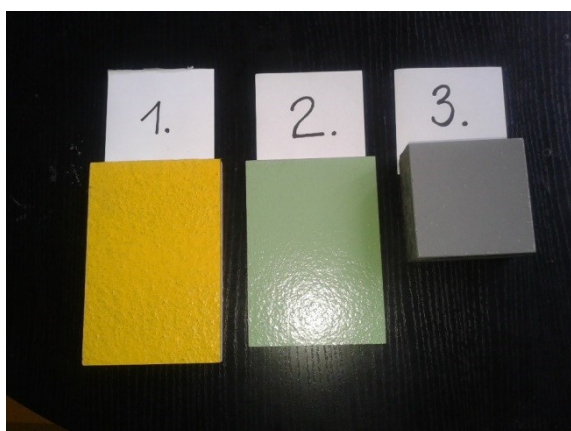
Obr. 3. Ochranný nátěr polyuretan (1), epoxid (2), epoxid na vsypu (3). Foto P. Hájek.
