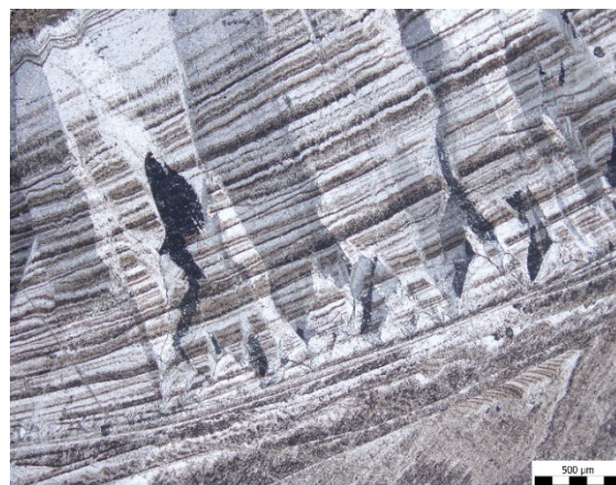
Obr. 3. Tektonické porušení přírůstových zón kanálku kalcitovou hmotou krápníčku. Polarizační mikroskop. Foto M. Šťastný.
