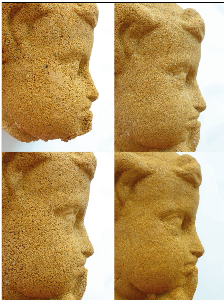
Obr. 2. Presentace různé kvality povrchové modelace výdusků v závislosti na zrnitosti použitých písků a množství pojiva ( vlevo nahoře – písek do 2 mm a 20 % pojiva, vlevo dole – písek do 2 mm a obsah pojiva 17 %, vpravo nahoře – písek do 1 mm a 17 % pojiva, vpravo dole – písek do 0,5 mm a 17 % pojiva)
