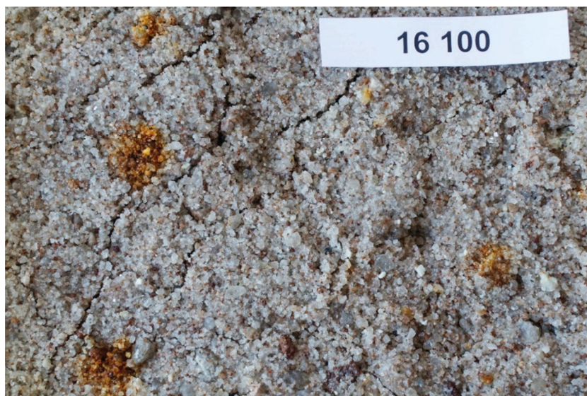
Obr. 1. Zřetelné lokální barevné změny vlhkého šedého písku č. 2 po 14 dnech trvání experimentu
